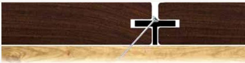
Originální schéma DeckWise: vrut prochází klipem, prknem a do hranolu.
